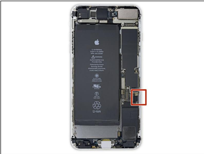
⚠ An der rechten Kante deines iPhones verläuft ein empfindliches Kabel. **Setze dein Plektrum hier nicht ein**, da sonst das Kabel beschädigt werden könnte.
