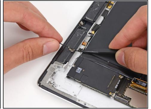
**⚠** In diesem Schritt werden die zwei Stücke von Klebeband entfernt, mit denen das Mobilfunkantennenkabel am Rückgehäuse festgeklebt ist.
