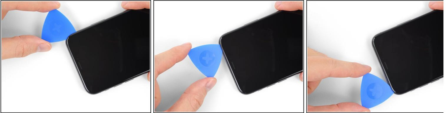
**i** Die Oberkante des Displays ist mit Klebstoff und mit Klammern befestigt.
