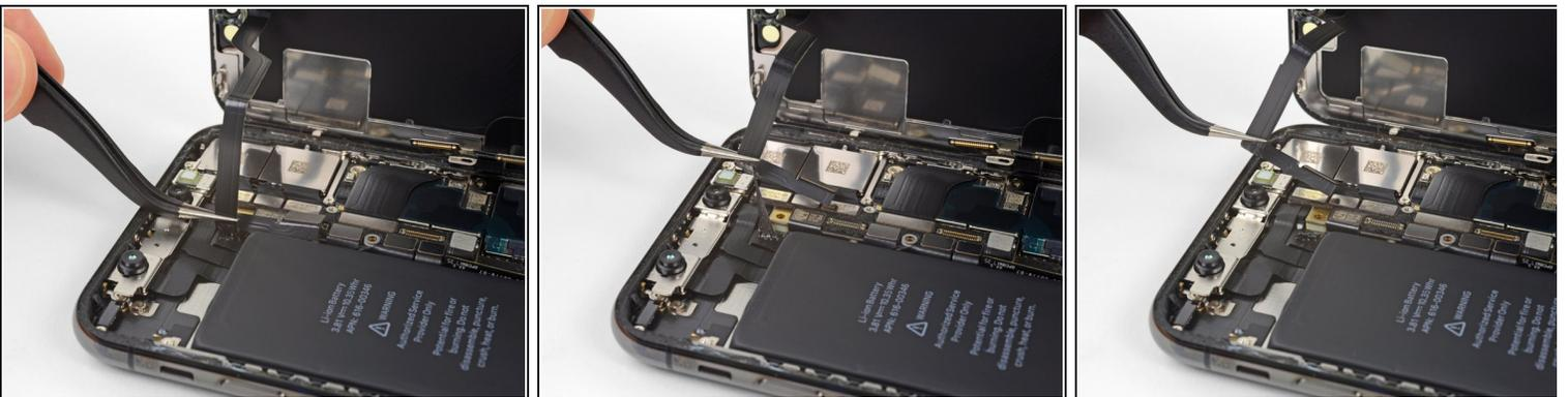
**i** Das Flachbandkabel der Sensoreinheit am Frontpanel ist leicht festgeklebt.
