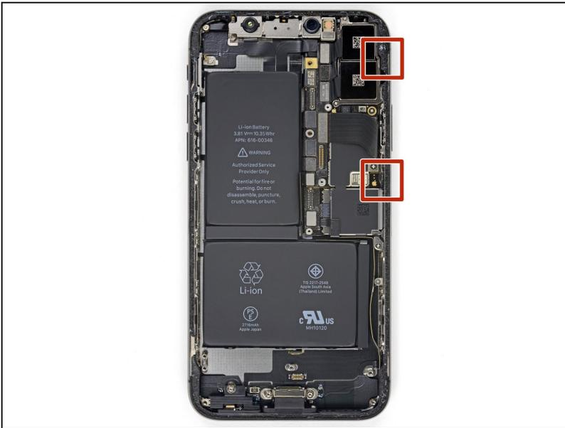
⚠ An der rechten Kante des iPhones verlaufen empfindliche Kabel. **Setze an diesen Stellen kein Plektrum ein**, du könntest sonst die Kabel beschädigen.
