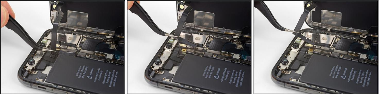
ⓘ Das Flachbandkabel der Sensoreinheit am Frontpanel ist leicht festgeklebt.
