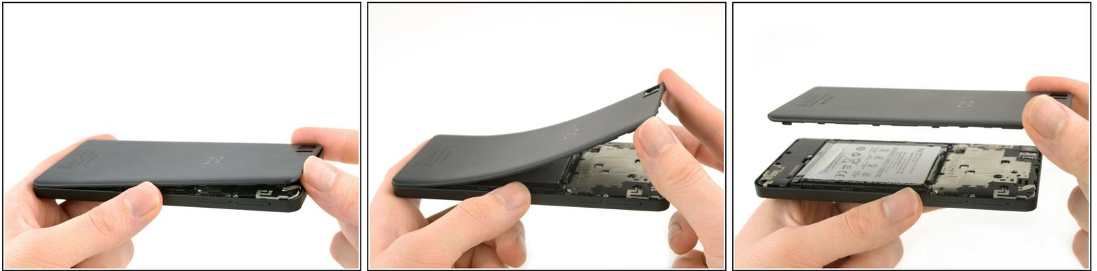
**⚠ Biege die Rückklappe nicht zu stark um keine Teile zu beschädigen.**
