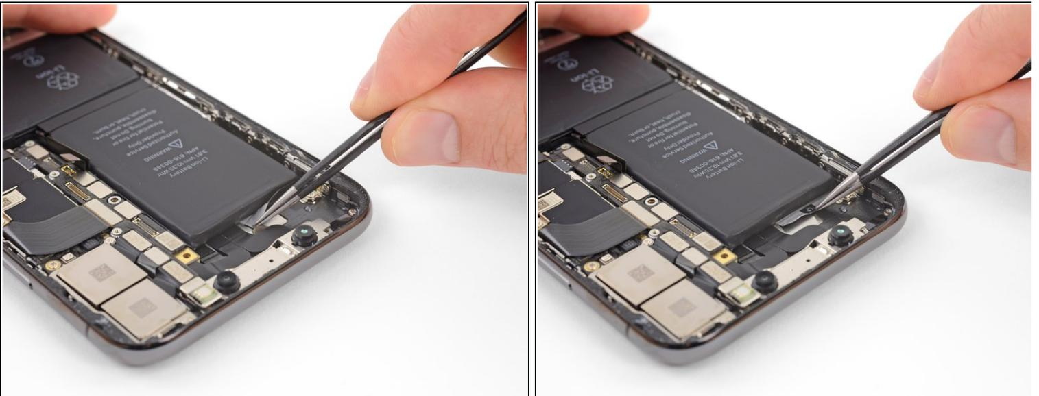
**⚠** Diese letzte Zuglasche befindet sich sehr nahe an der Hardware für die Face ID. Wenn sie beschädigt wird, kann diese Hardware nur von Apple repariert werden, sei deswegen sehr vorsichtig.
