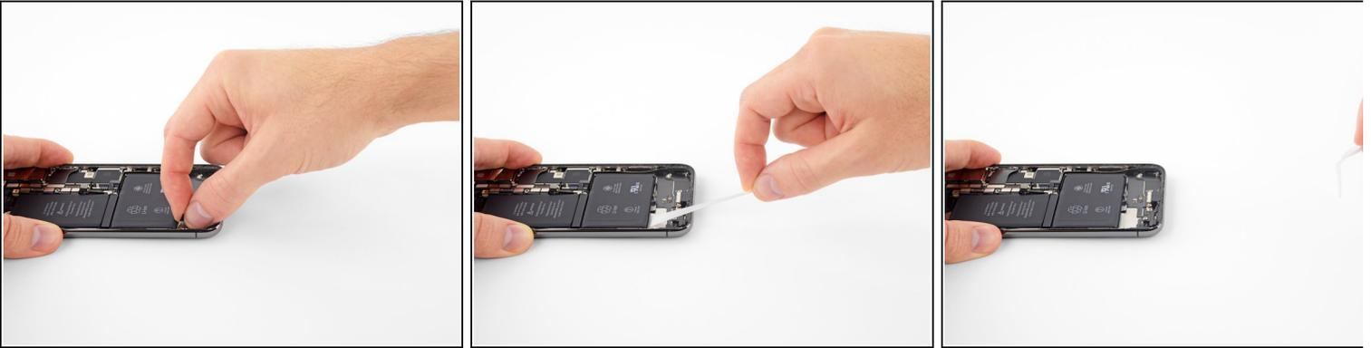
**i** In den folgenden Schritten wirst du jede Zuglasche herausziehen, um langsam die Klebestreifen unter dem Akku zu dehnen. Diese speziellen "Stretch-Release" Bänder verlieren ihre Klebekraft, wenn sie gedehnt werden, dann hast du sie in der Hand und kannst den Akku leicht entnehmen.
