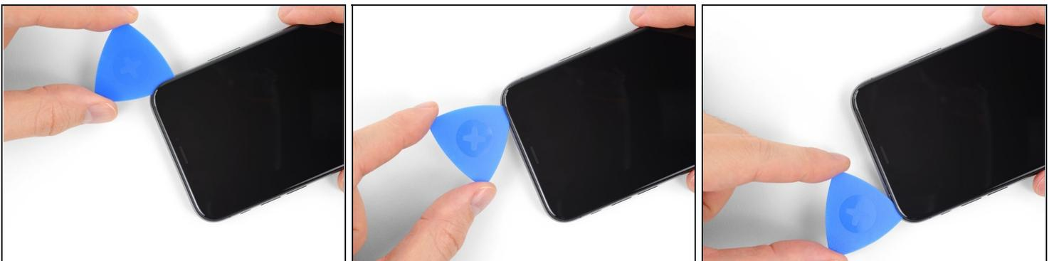
ⓘ Die Oberkante des Displays ist mit Klebstoff und mit Klammern befestigt.
