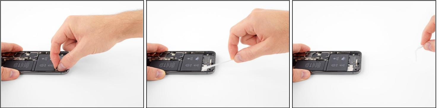
ⓘ In den folgenden Schritten wirst du jede Zuglasche herausziehen, um langsam die Klebestreifen unter dem Akku zu dehnen. Diese speziellen "Stretch-Release" Bänder verlieren ihre Klebekraft, wenn sie gedehnt werden, dann hast du sie in der Hand und kannst den Akku leicht entnehmen.
