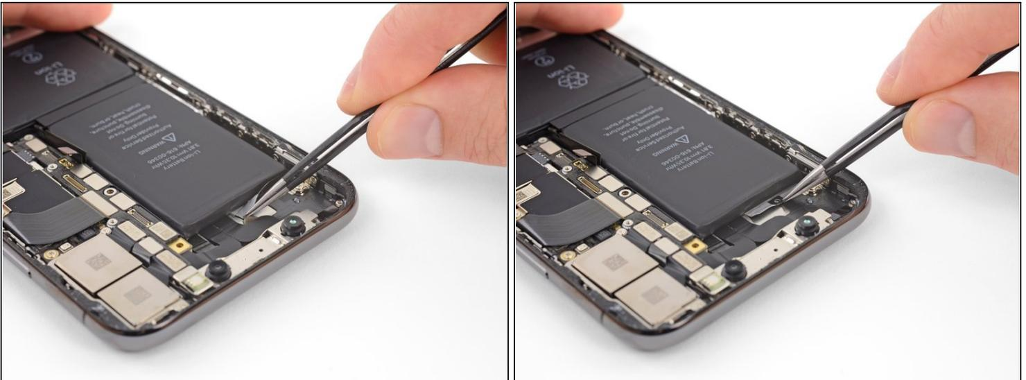
**⚠** Diese letzte Zuglasche befindet sich sehr nahe an der Hardware für die Face ID. Wenn sie beschädigt wird, kann diese Hardware nur von Apple repariert werden, sei deswegen sehr vorsichtig.
