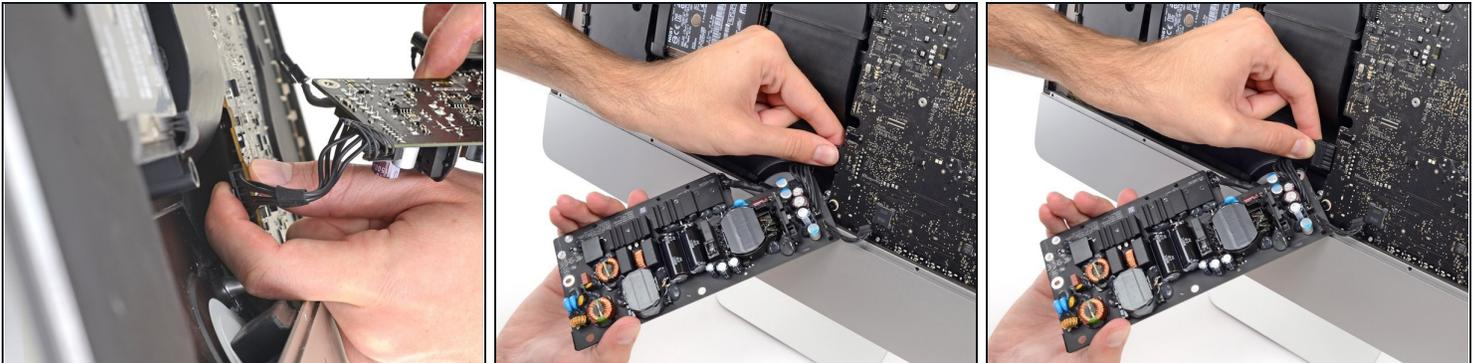
⚠ **Sei sehr vorsichtig** und berühre nicht die Anschlüsse der Kondensatoren oder offene Lötstellen auf der Rückseite des Netzteils. Fasse die Platine nur an den Kanten an.
