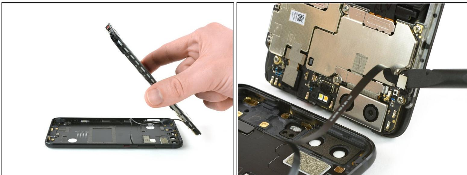
**⚠ Öffne das Smartphone noch nicht ganz, da das Kabel für die Standby- und Lautstärketasten noch mit der Rückabdeckung verbunden ist.**
