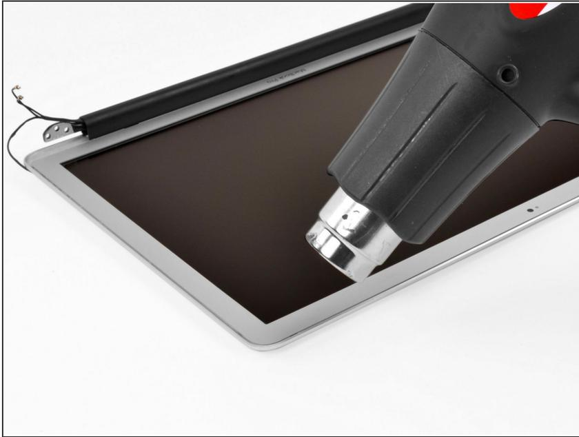
**i** In den folgenden Schritten wirst du mit einem Heißluftgebläse den Kleber aufweichen, mit dem der äußere silberfarbenen Rand um die Unterseite der Frontscheibe am Display befestigt ist.
