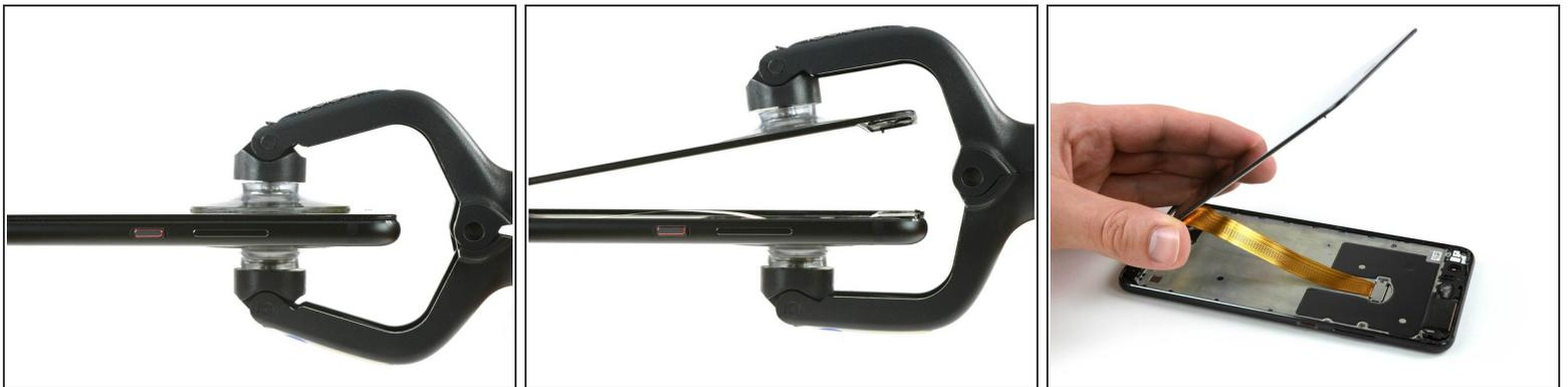
**⚠ Der Bildschirm ist durch ein dünnes Displaykabel mit dem restlichen Smartphone verbunden. Achte sehr darauf, dieses Kabel beim Öffnen des Gerätes nicht zu zerreißen.**
