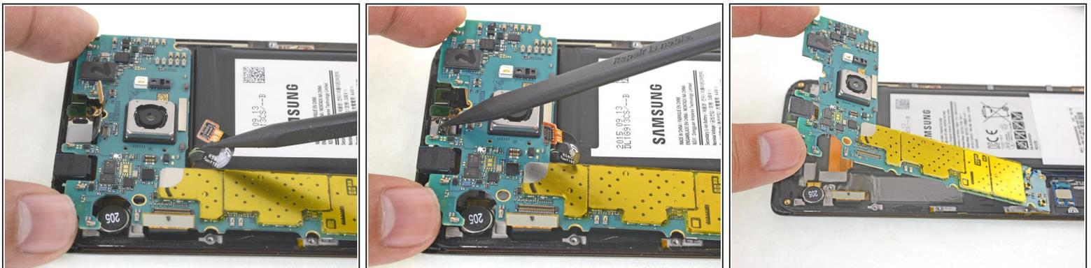
**⚠** Entferne die Hauptplatine noch **nicht** vollständig — es ist noch mit dem Flachbandkabel der Tochterplatine an der Unterseite des Hauptplatine befestigt.
