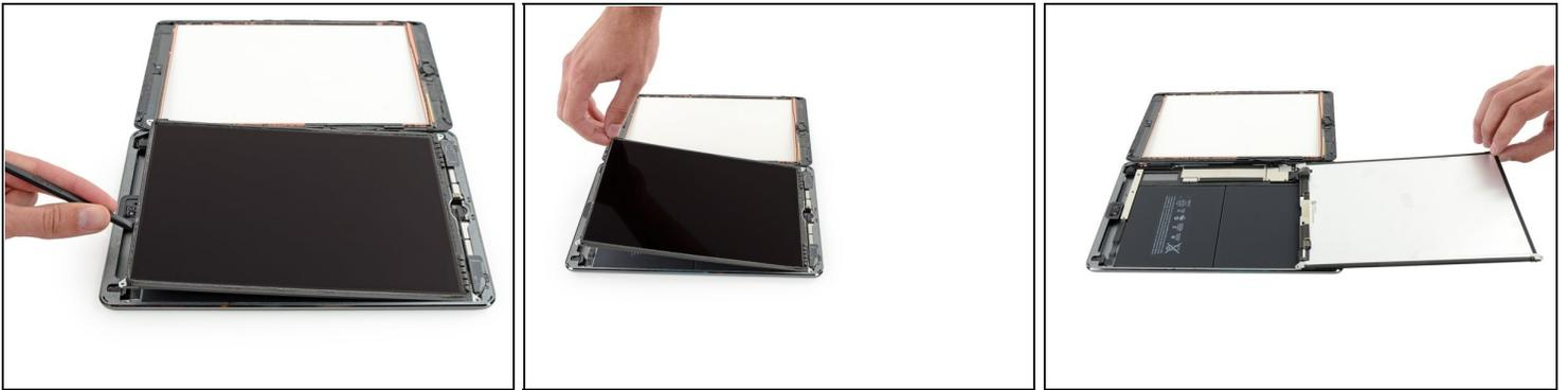
**⚠ Versuche nicht, das LCD ganz zu entfernen. Es ist noch mit verschiedenen Kabeln am Ende mit dem Home Button angeschlossen. Hebe es nur am Ende mit der Frontkamera an.**
