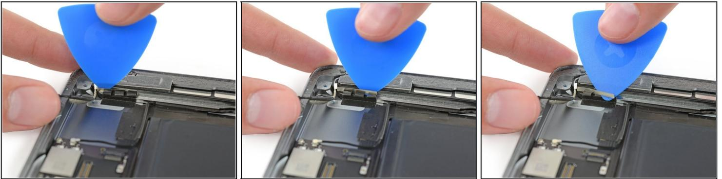
ⓘ Das Antennenkabel ist mit einer kleinen Metallklammer am Lautsprecher befestigt. Die Klammer umfasst das Antennenkabel permanent und klebt am Lautsprechergehäuse.
