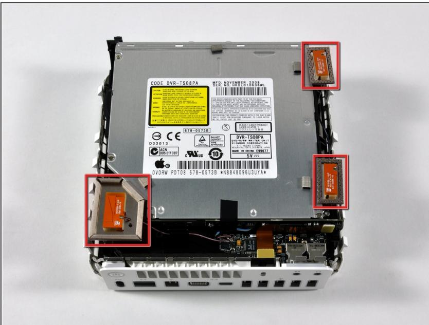
**⚠** In den nächsten Schritten wirst du die AirPort- und Bluetooth-Antennen (rot markiert) vom inneren Rahmen entfernen. Arbeite sehr behutsam. Wenn die Rasten abbrechen, muss der innere Rahmen ersetzt werden.
