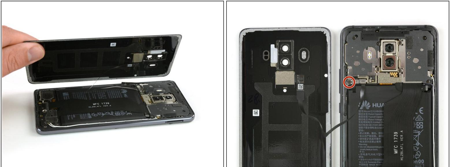
**!** Entferne die Rückabdeckung noch nicht ganz. Das Kabel des Fingerabdrucksensors ist immer noch an der Hauptplatine angeschlossen.
