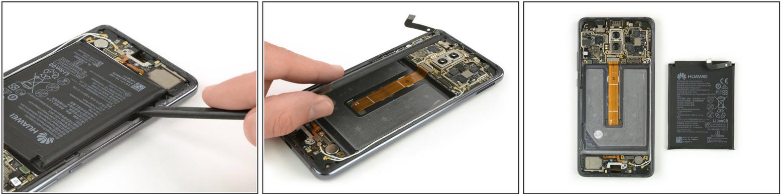
**⚠** Das Flachbandkabel zum Display verläuft unter dem Akku. Achte beim Ablösen des Klebers darauf, dass du es nicht beschädigst. Achte auch darauf, dass du den Akku niemals anstichst oder verbiegst.
