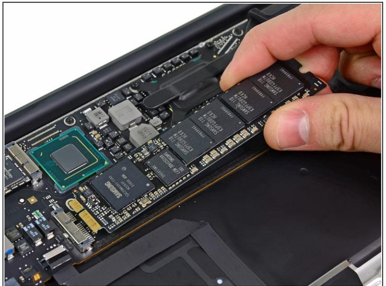
**⚠ Um Schäden am Anschluss zu vermeiden, hebe das Ende der SSD nicht zu stark an.**
