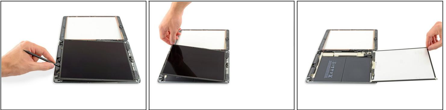
**⚠ Versuche noch nicht, das LCD ganz zu entfernen. Es ist immer noch mit dem iPad über verschiedene Kabel am Ende nahe des Home Buttons verbunden. Hebe es nur am Ende nahe der Frontkamera an.**
