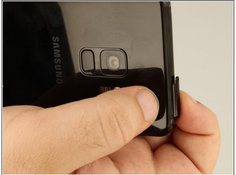
**⚠** Das Auswurfloch des SIM-Kartenfachs und das Mikrofonloch sehen sehr ähnlich aus. Passe also auf, dass du das Werkzeug nicht in das Mikrofonloch einführst, da du sonst das Mikrofon beschädigen könntest.
