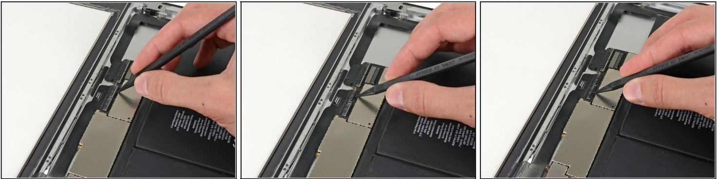
ⓘ Falls notwendig, löse das Stück Tape, dass das Digitizer Flachbandkabel am Logic Board befestigt.
