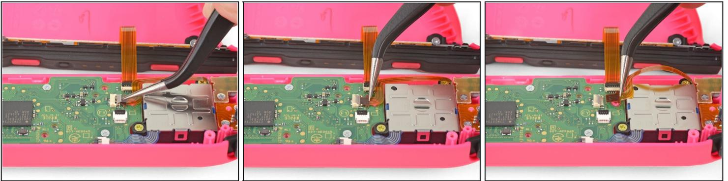
ⓘ Das Flachbandkabel, das den Minus Button des Joy-Cons mit dem Motherboard verbindet, verläuft über die Rückseite des Joysticks. Du kannst den Joystick zwar ausbauen, ohne das Kabel zu lösen, aber es ist viel einfacher, wenn es entfernt ist und nicht stört.
