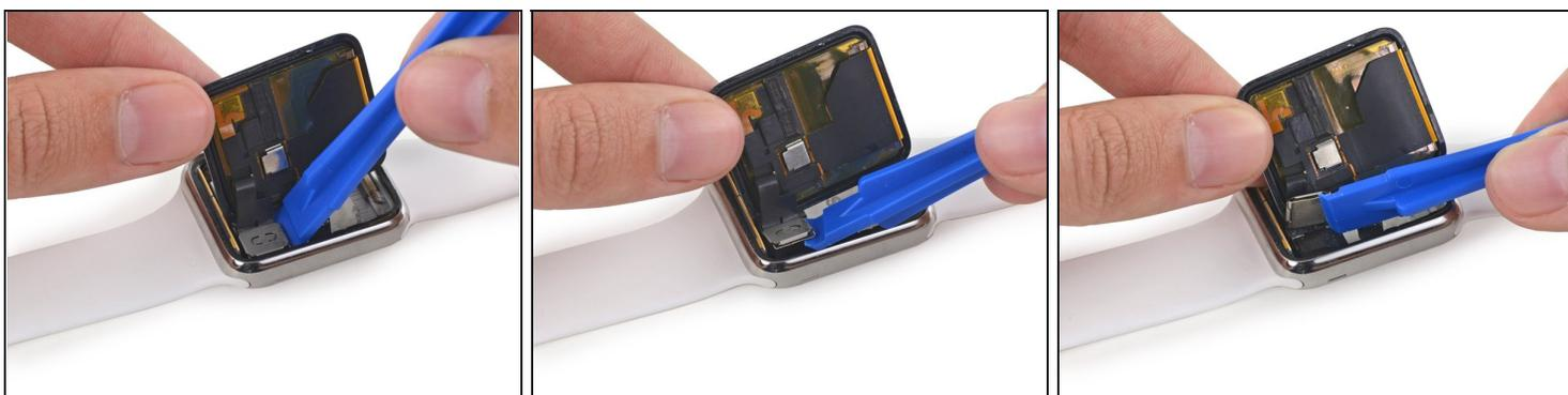
ⓘ Il connettore del cavo del display e del touch sono fissati al di sotto di una piccola staffa metallica che aderisce all'altoparlante.
