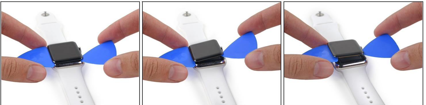
**⚠** Der Bildschirm ist mit zwei Kabeln im Inneren der Uhr in der linken oberen Ecke angeschlossen. Sei vorsichtig beim Hebeln, um diese nicht zu beschädigen.
