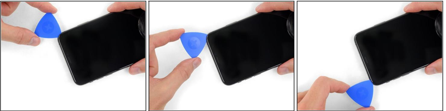
ⓘ Die Oberkante des Displays ist sowohl mit Kleber als auch mit Clips befestigt.
