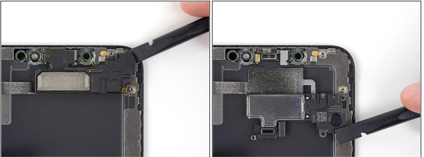
ⓘ Der Ohrhörer-Lautsprecher ist leicht angeklebt.
