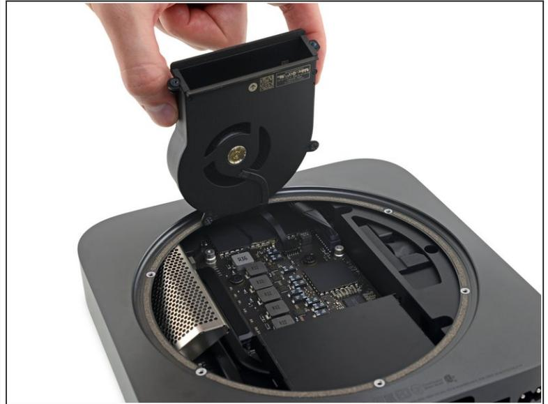
**⚠** Versuche in diesem Schritt noch nicht den Lüfter ganz zu entfernen - hebe ihn nur so weit hoch, dass du an das darunterliegende Kabel gelangen kannst.
