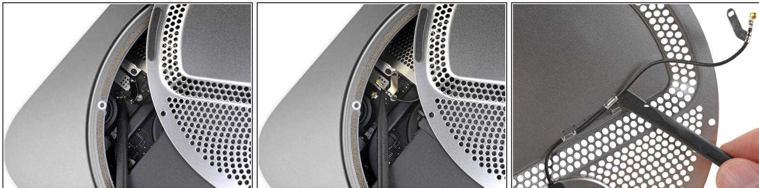
**⚠ Der Stecker des Antennenkabels und der Anschluss sind sehr empfindlich.**
