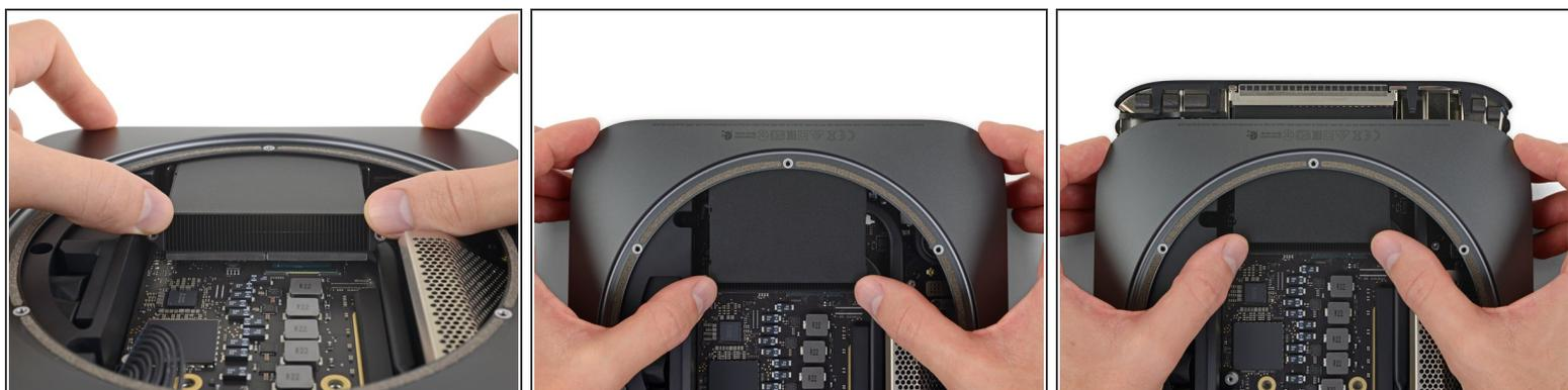
**⚠** In diesem Schritt sollst du das Logic Board aus den Klammern herauschieben, mit denen es am Rahmen befestigt ist. **Drücke nur an den angezeigten Stellen**, sonst könntest du die empfindlichen Kühl lamellen beschädigen.
