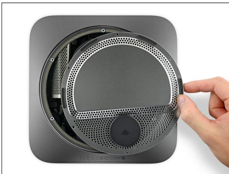
**⚠ Entferne die Antennenplatte noch nicht, sie ist immer noch mit dem Antennenkabel am Mac Mini angeschlossen.**
