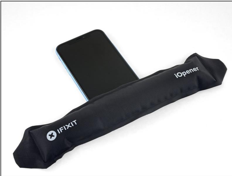
ⓘ Es ist hilfreich, die Unterkante des iPhones zu erhitzen, um den Kleber, mit dem das Display befestigt ist, aufzuweichen. So lässt sich das Gerät leichter öffnen.
