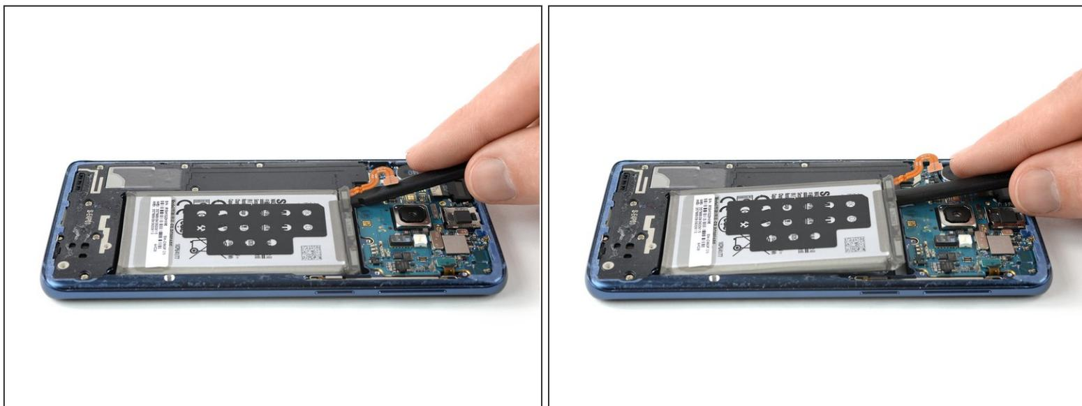
**i** Wenn sich der Akku nicht leicht abhebeln lässt, ist der Kleber vielleicht nicht genug gelöst. Du kannst etwas Isopropylalkohol unter jede Ecke des Akkus träufeln und einige Minuten lang einwirken lassen, damit der Kleber geschwächt wird.
