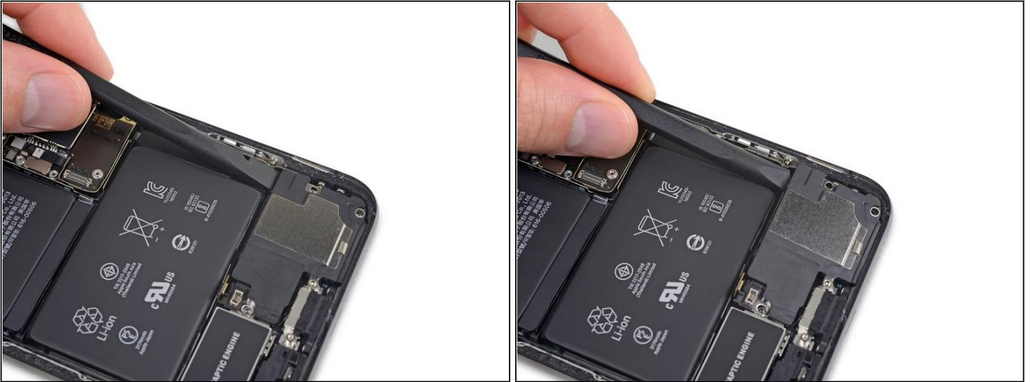
**⚠ Achte darauf, beim Hochhebeln des Lautsprechers nicht das Lautsprecherkabel zu beschädigen, das du gerade abgelöst hast. Wenn nötig, kannst du das Kabel zum Akku hinbiegen, sodass mehr Platz da ist.**
