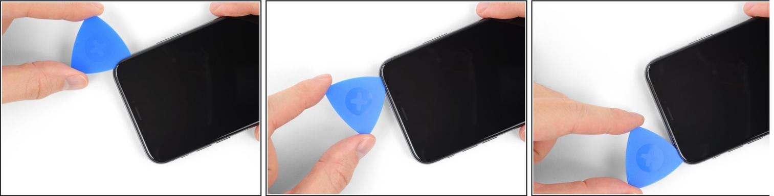
**i** Die Oberkante des Displays ist sowohl mit Kleber als auch mit Klammern befestigt.
