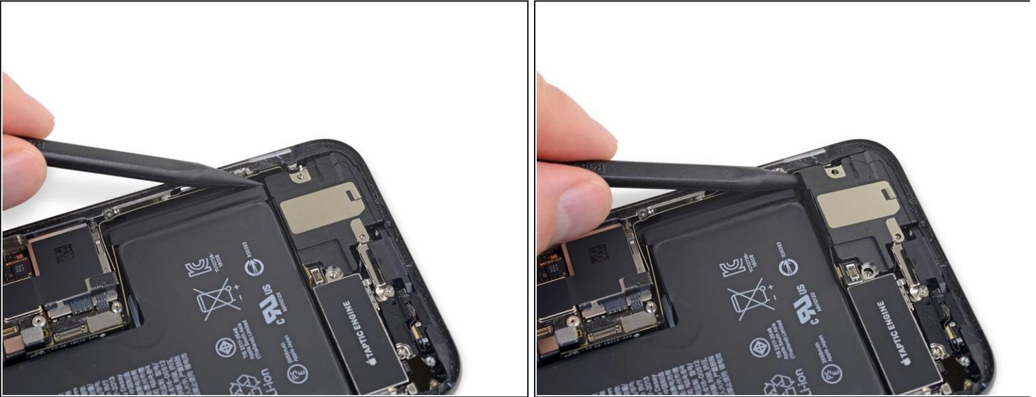
**⚠** Achte darauf, beim Hochhebeln des Lautsprechers nicht das Lautsprecherkabel zu beschädigen, das du gerade abgelöst hast. Wenn nötig, kannst du das Kabel zum Akku hinbiegen, sodass mehr Platz da ist.
