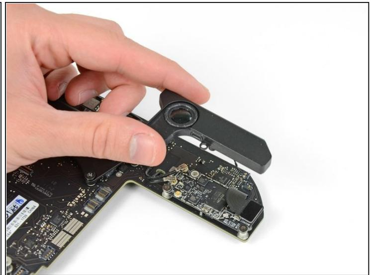
**⚠** Hebe die Lautsprechereinheit etwas hoch, aber entferne sie nicht ganz. Der Lautsprecher ist noch durch den Lautsprecherverbinder am Logic Board angeschlossen.
