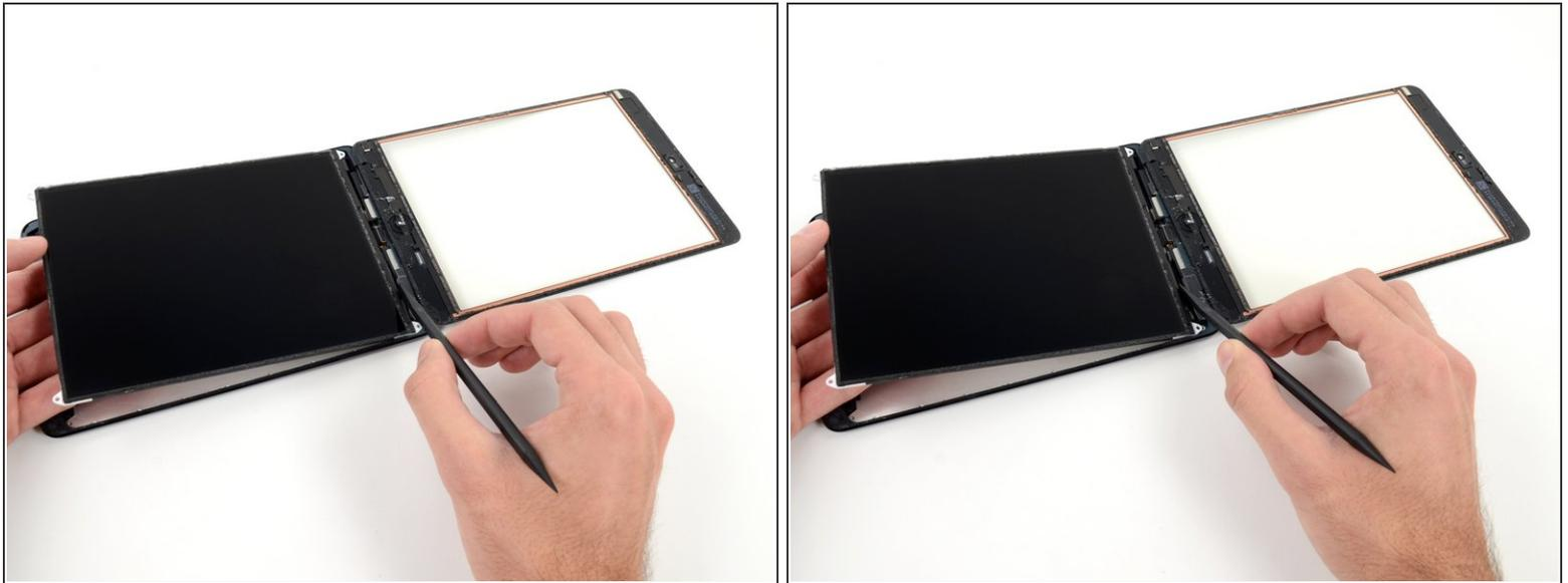
**i** Zwei breite Klebestreifen verbinden das LCD mit den Lautsprechern.
