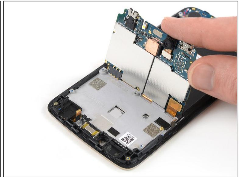
**!** Versuche noch nicht, das Motherboard ganz zu entfernen. Das Displaykabel ist immer noch auf der Rückseite angeschlossen.
