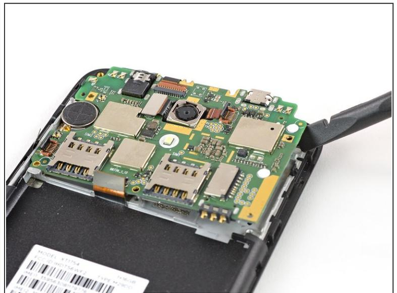
**⚠** Versuche noch nicht, das Motherboard ganz zu entfernen. Das Antennenkabel ist noch auf der Rückseite angeschlossen.
