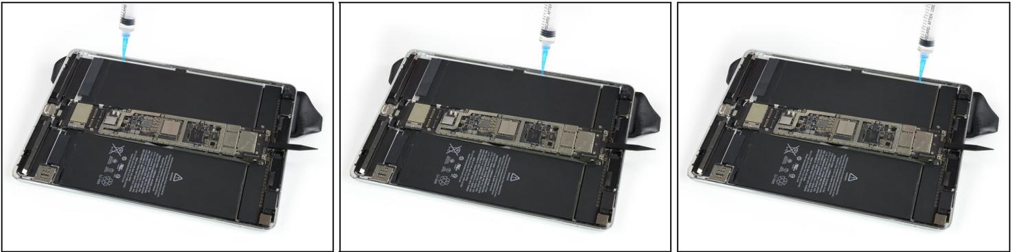
**⚠ Wende beim Flachbandkabel zum Smart Connector kein Lösungsmittel an, damit es sich beim Ausbau des Akkus nicht ablöst.**
