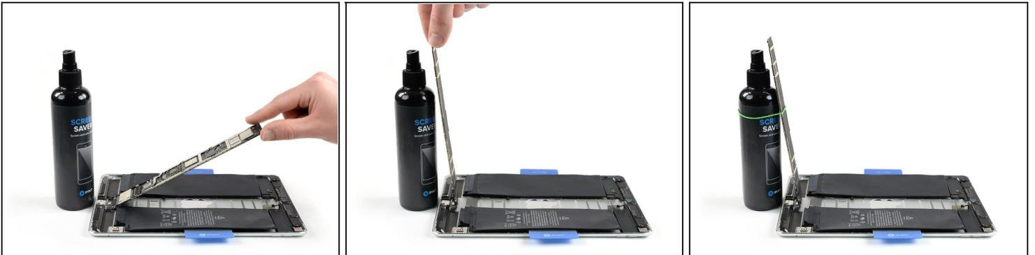
**⚠ Klappe bei diesem Schritt das Logic Board nicht mehr als 100° auf. Einige Stecker sind immer noch verbunden und könnten beschädigt werden.**
