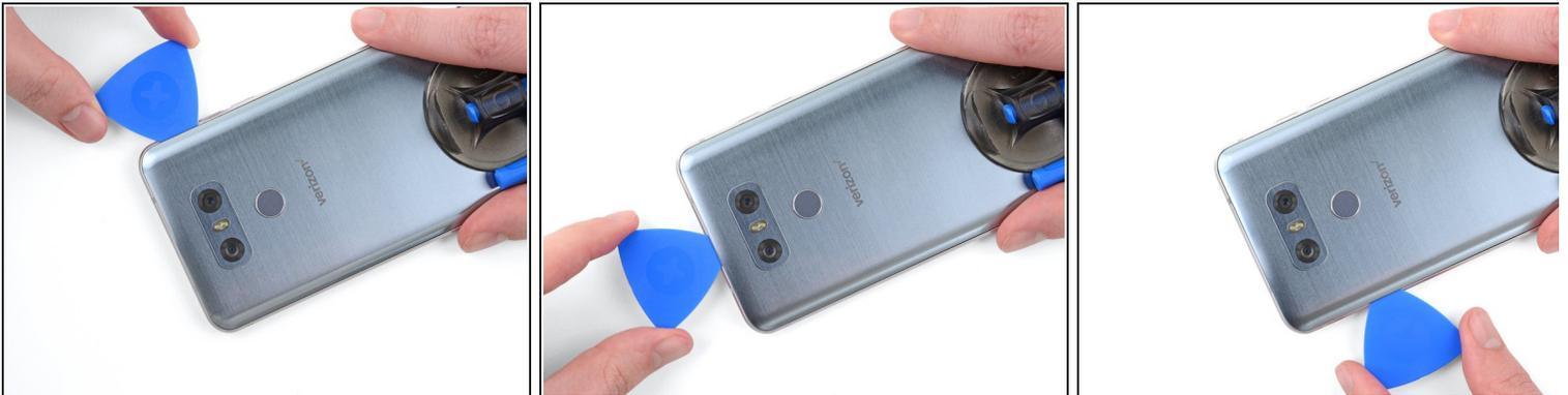
**⚠** Wie in [Schritt 1](#) zu sehen war, verläuft das Kabel zum Fingerabdrucksensor links von der Kamera ziemlich nahe an der Kante des Smartphones entlang. Sei deswegen beim Auftrennen des Klebers an den oberen Kanten des Smartphones besonders vorsichtig.
