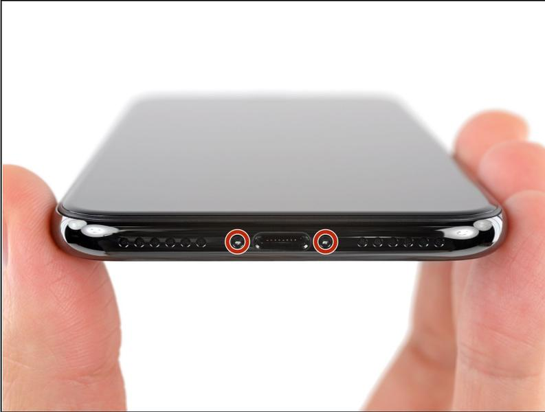
**⚠** Bevor du anfängst, sollte der Akku deines iPhones auf unter 25% entladen sein. Ein geladener Lithium-Ionen Akku kann Feuer fangen und/oder explodieren, wenn er beschädigt wird.
