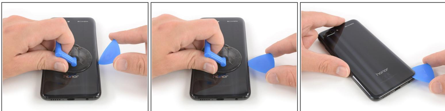
**i** Wenn die Glasrückseite zerbrochen ist, hält der Saugheber möglicherweise nicht gut. Versuche [sie mit starkem Klebeband anzuheben](#), oder klebe den Saugheber mit Sekundenkleber fest und lasse ihn gut trocknen, bevor du weiterarbeitest.
