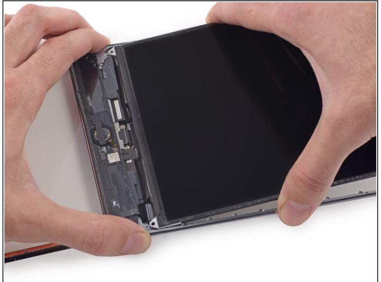
**i** Das LCD ist mit zwei breiten Klebestreifen mit den Lautsprechern verbunden.
