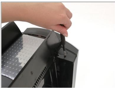
Entferne die 2 Senkkopfschrauben der Gehäuseabdeckung der Kaffeemaschine mit dem Schraubendreher Torx T15.
