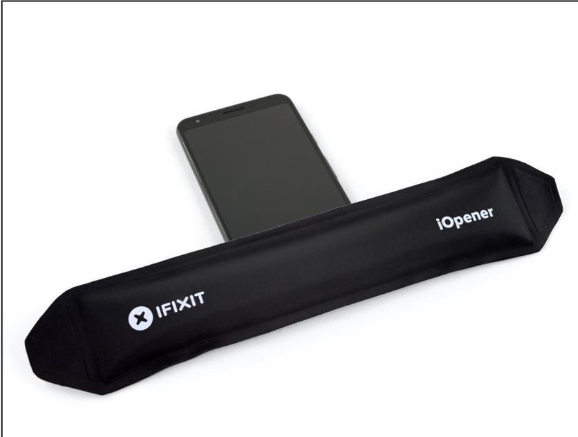
**i** Der Kleber, mit dem die Unterkante des Displays befestigt ist, ist dicker und wesentlich stärker, als die dünnen Klebestreifen an den Seitenkanten.
