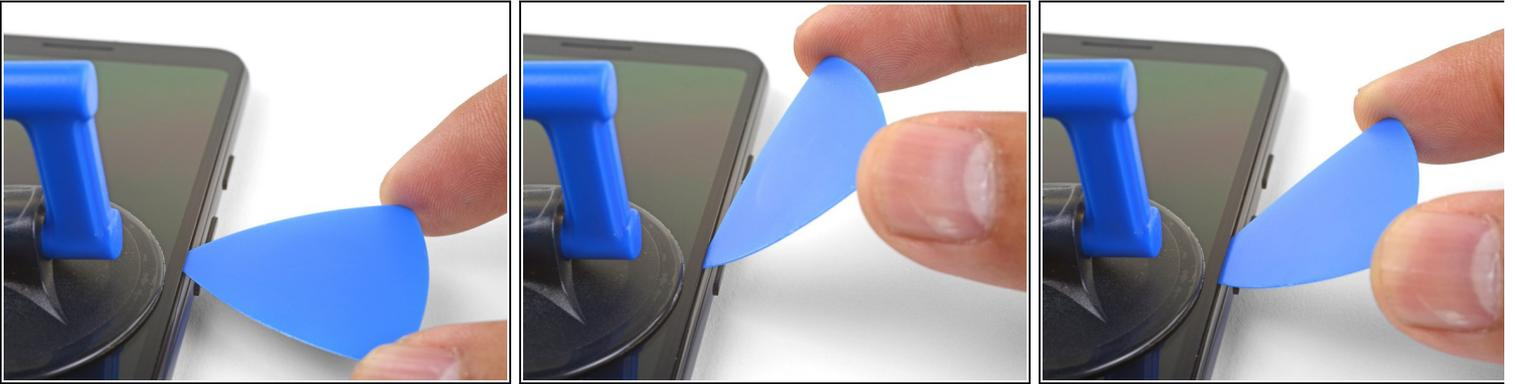
**i** In diesem Schritt erfährst du, wie du das Plektrum einsetzen musst, damit das OLED-Panel nicht beschädigt wird. Das solltest du beachten, bevor du die langen Kanten des Smartphones auftrennst.
