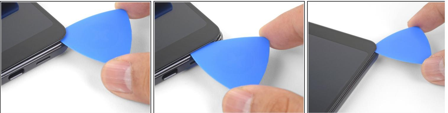
**i** Wenn du an der Unterkante des Smartphones schneidest, darfst du das Plektrum nicht tiefer als 6 mm einsetzen.
