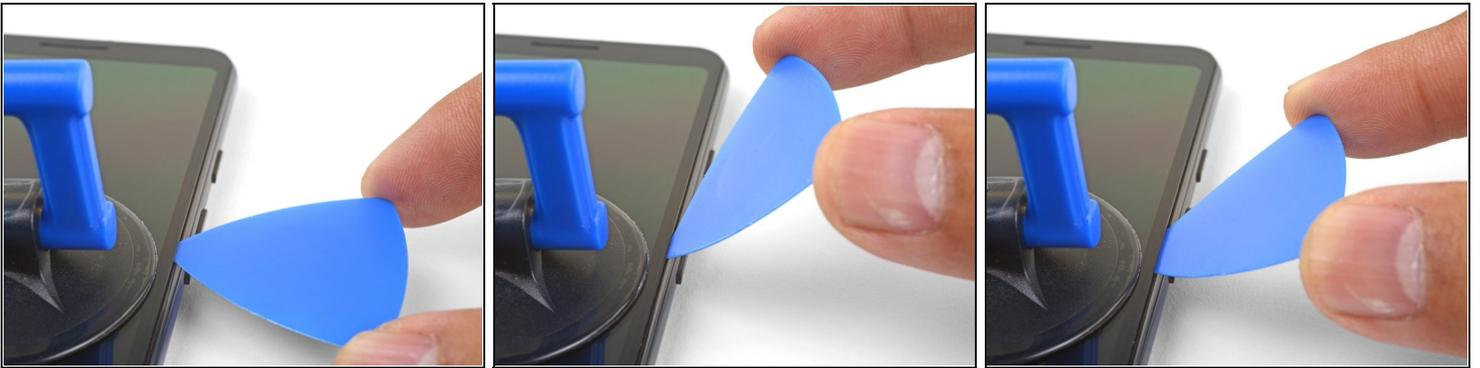
ⓘ In diesem Schritt erfährst du, wie du das Plektrum einsetzen musst, damit das OLED-Panel nicht beschädigt wird. Das solltest du beachten, bevor du die langen Kanten des Smartphones auftrennst.
