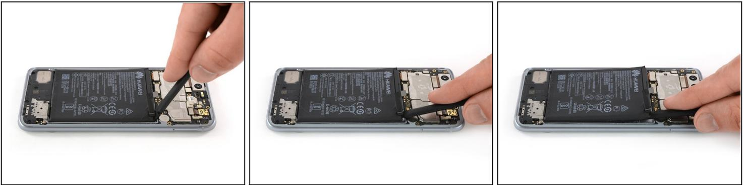
**⚠ Vermeide es nach Möglichkeit, den Akku beim Ausbau zu verformen. Aus Lithium-Ion-Akkus mit weicher Hülle können gefährliche Chemikalien austreten, sie können sich entzünden oder sogar explodieren, wenn sie beschädigt werden. Heble nicht zu stark und benutze keine Metallwerkzeuge.**
