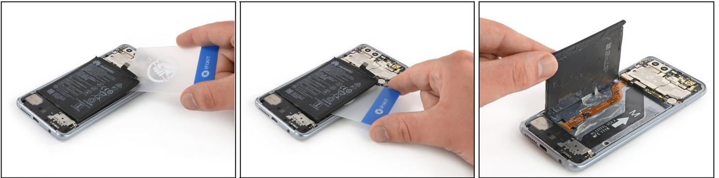
**⚠** Das Display- sowie das Zwischenverbindungskabel verlaufen unter dem Akku. Beschädige sie nicht, wenn du den restlichen Kleber ablöst.
