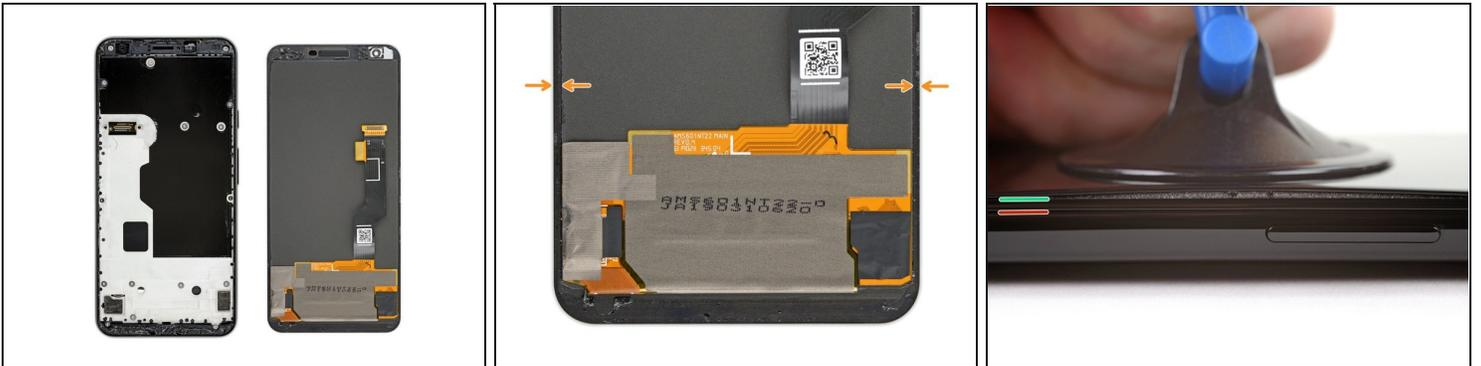
**i** In den folgenden Schritten wird das Display des Pixel 3a entfernt, indem der Kleber, mit dem es befestigt ist, durchtrennt wird.
