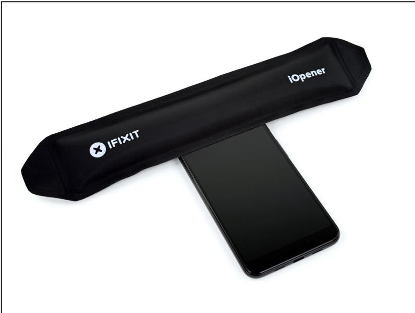
**i** Der Kleber, mit dem die Ober- und die Unterkante des Displays befestigt ist, ist dicker und wesentlich stärker, als die dünnen Klebestreifen an den Seitenkanten.
