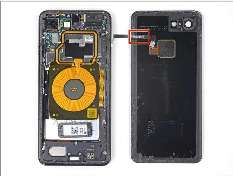
⚠ Sei vorsichtig, wenn du oberhalb der Einschalttaste hebelst und setze das Werkzeug nicht zu tief ein, du könntest sonst das Flachbandkabel zum Fingerabdrucksensor beschädigen.
