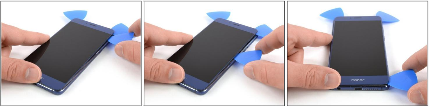
⚠ Achte beim Schneiden darauf, dass sich das Plektrum **unter dem Displaypanel** befindet und nicht nur zwischen dem Display und dem vorderen Glaspanel.
