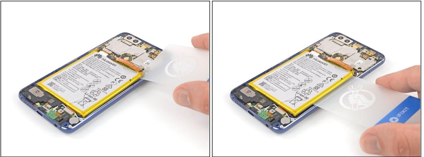
**⚠ Vermeide es nach Möglichkeit, den Akku beim Ausbau zu verformen. Aus Lithium-Ion-Akkus mit weicher Hülle können gefährliche Chemikalien austreten, sie können sich entzünden oder sogar explodieren, wenn sie beschädigt werden. Heble nicht zu stark und benutze keine Metallwerkzeuge.**
