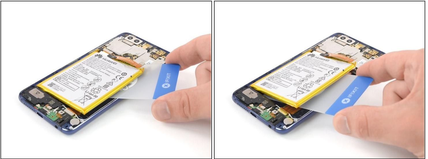
**⚠ Das Display- sowie das Zwischenverbindungskabel verlaufen unter dem Akku. Beschädige sie nicht, wenn du den restlichen Kleber ablöst.**
