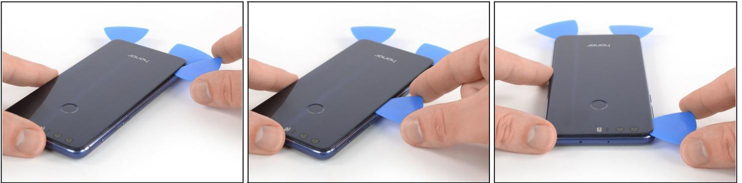
**⚠ Das Kabel des Fingerabdrucksensors verläuft über dem Power Button und den Lautstärkereglern auf dieser Seite des Telefons. Verwende nur die Spitze des Plektrums, um Schäden zu vermeiden.**
