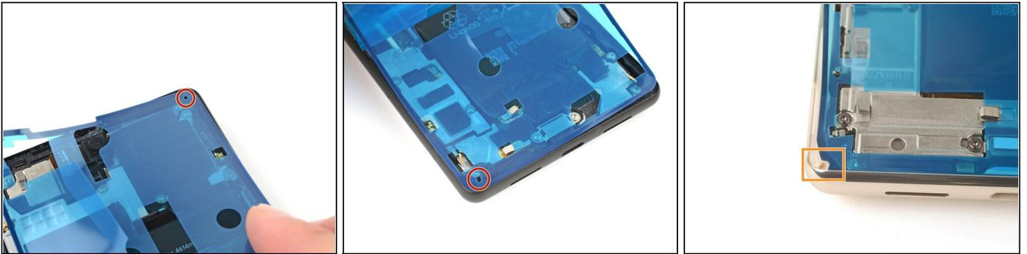
⚠ Sei beim Auflegen der Klebestreifen sehr sorgfältig. In den meisten Fällen kann der Klebestreifen, wenn er nicht genau passend aufgelegt wurde, nicht wieder abgelöst und erneut aufgeklebt werden. Du musst dann einen neuen Streifen verwenden.
