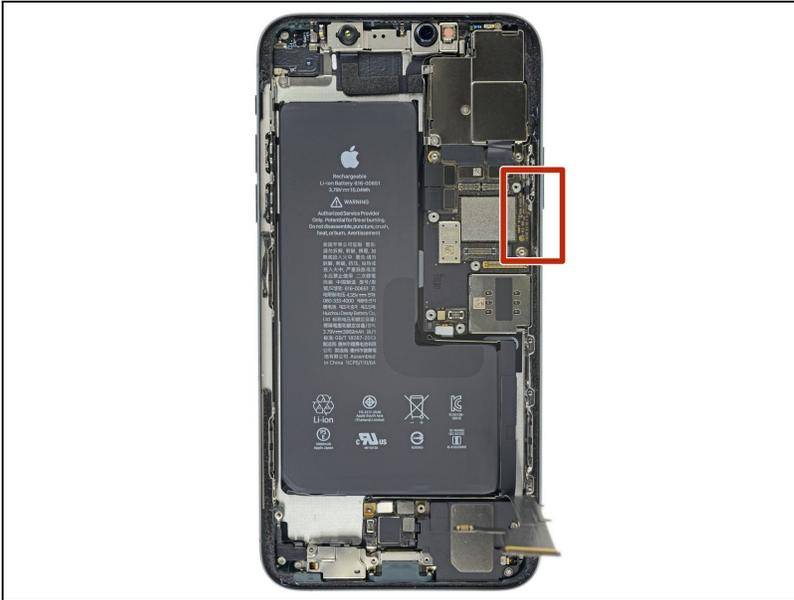
⚠ An der rechten Seitenkante verläuft ein empfindliches Kabel. **Setze das Plektrum an diesen Stellen nicht ein**, das Kabel könnte beschädigt werden.
