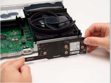
Retirez délicatement l'IR Blaster du châssis métallique.
