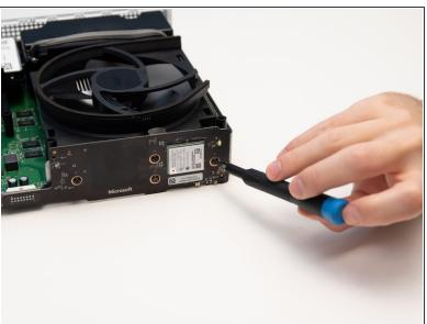
Retirez les quatre vis de 15 mm fixant l'IR Blaster au châssis métallique à l'aide du tournevis Torx T8 Security.
